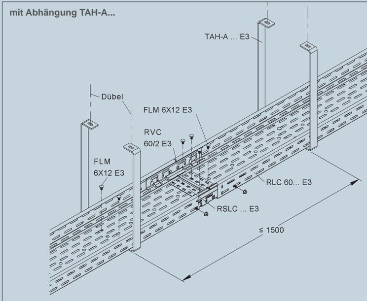
Kabelrinnen mit einer Holmhöhe von 60 mm, in den Breiten 100 bis 300 mm (RLC 60.100 E3 OV - RLC 60.300 E3 OV) finden Verwendung in der Deckenmontage. Die Verbindung zweier Kabelrinnen RLC 60... erfolgt über die Stoßstellenverbinder RVC 60/2 E3 (je Verbinder 2 FLM 6X12 E3) und der Stoßstellenleiste RSLC... (4 FLM 6X12 E3).
