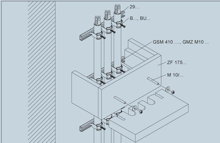
Für die Montage der Zugentlastung ZF... wird kein spezielles Werkzeug benötigt. Bohren der Befestigungslöcher kann mit einem HSS Bohrer für Stahl erfolgen.
