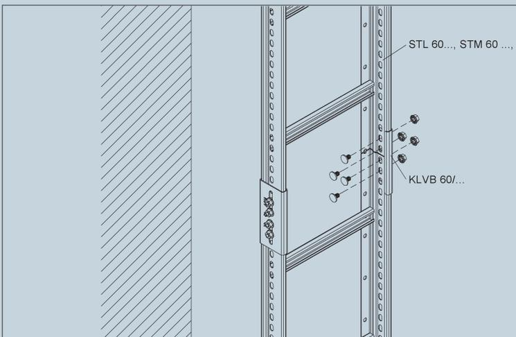
Die Verbindung zweier Steigtrassen STL 60... / STM 60... erfolgt über die Kabelleiter - Längsverbinder KLVB 60/4 mit 4 Flachrundkopfschrauben FLM 8X13 je Verbinder.
