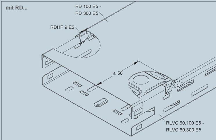
Kommen Deckel RD...E5 mit Deckelhalterfeder RDHF 9 E2 bzw. RDV... E5 und Formstückdeckel RTADV ... E5, RBADV ... E5, RESDV ... E5 und RTSDV ... E5 zum Einsatz, ist das max. zulässige Kabelgewicht um das Gewicht des Deckels zu reduzieren.
