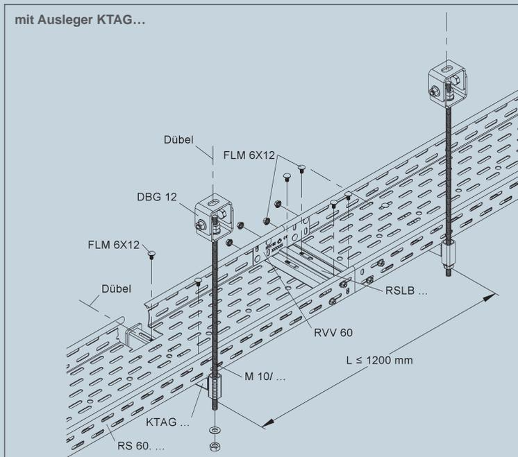
Kabelrinnen mit einer Holmhöhe von 60 mm, in den Breiten 100 bis 300 mm (RS 60.100 OV - RS 60.300 OV) finden Verwendung bei der Decken- und Wandmontage. Die Kabelrinnen werden auf den Auslegern mit 2 Flachrundkopfschrauben (FLM 6X12/FLM 6X16 F) befestigt.
