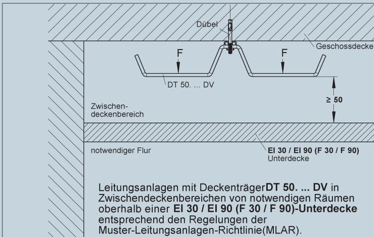
Der Deckenträger (DT 50...) findet Verwendung bei der Leitungsführung von Installationen im Zwischendeckenbereich oberhalb von Brandschutzdecken.
