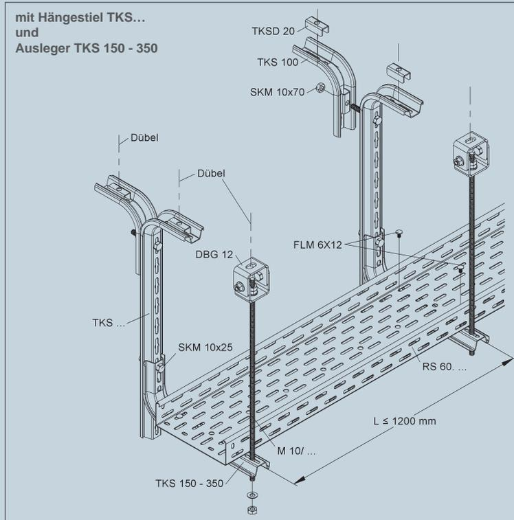
Kabelrinnen mit einer Holmhöhe von 60 mm, in den Breiten 100 bis 300 mm (RS 60.100 OV - RS 60.300 OV) finden Verwendung bei der Decken- und Wandmontage. Die Kabelrinnen werden auf den Auslegern mit 2 Flachrundkopfschrauben (FLM 6X12/FLM 6X16 F) befestigt.
