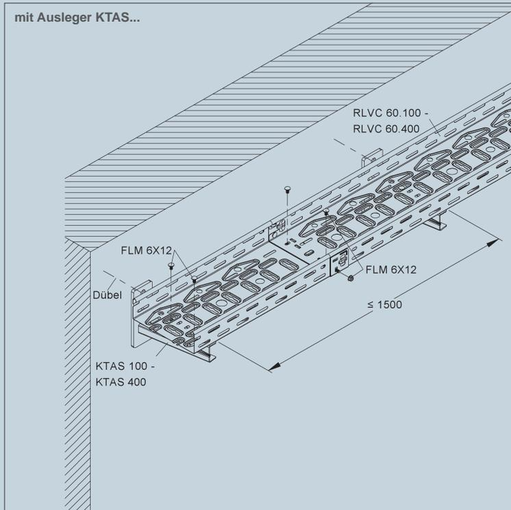
Kabelrinnen mit einer Holmhöhe von 60 mm, in den Breiten 100 bis 400 mm (RLVC 60.100 - RLVC 60.400) finden Verwendung bei der Decken- und Wandmontage.
