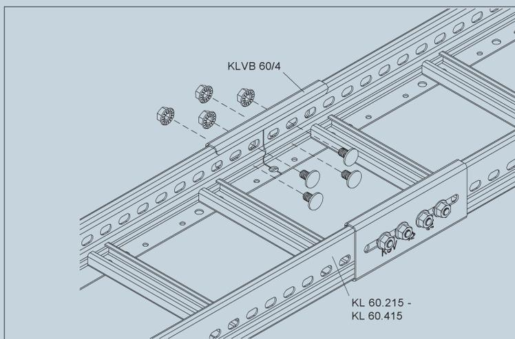
Die Verbindung zweier Kabelleiter KL 60... erfolgt über die Kabelleiter - Längsverbinder KLVB 60/4 mit 4 Flachrundkopfschrauben FLM 8X13 je Verbinder.
