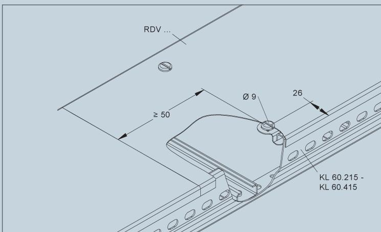
Werden Deckel RDV... verwendet, ist das max. zulässige Kabelgewicht um das Gewicht des Deckels zu reduzieren.
