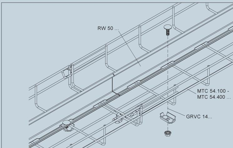
Um bei einer Mischbelegung eine Überlagerung von Leitungen der allgemeinen Stromversorgung und Sicherheitsstromversorgung zu vermeiden, kann ein Trennsteg RW... verwendet werden. Dieser wird mittels der Trennstegbefestigungsklemme GRVC 14 befestigt.
