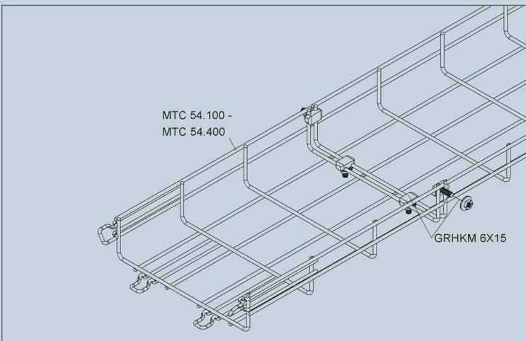
Die Verbindung zweier geschnittener Gitterrinnenenden der MTC 54... erfolgt über den zweiteiligen Universalverbinder GRHKM 6X15.
