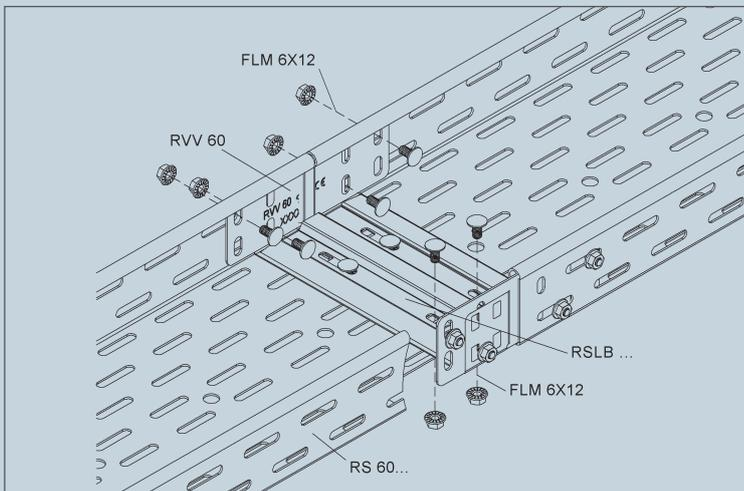
Die Verbindung zweier Kabelrinnen RS 60... erfolgt über die Stoßstellenverbinder RVV 60 (je Verbinder 4 FLM 6X12) und der Stoßstellenleiste RSLB... (4 FLM 6X12) gemäß nebenstehender Abbildung.
