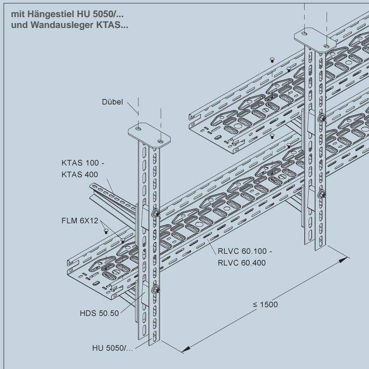
Kabelrinnen mit einer Holmhöhe von 60 mm, in den Breiten 100 bis 400 mm (RLVC 60.100 - RLCV 60.400) finden Verwendung bei der Decken- und Wandmontage. Die Kabelrinnen werden auf den Auslegern mit 2 Flachrundkopfschrauben FLM 6X12 befestigt.
