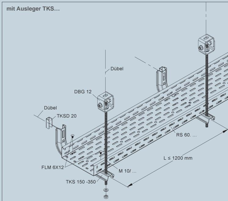
Kabelrinnen mit einer Holmhöhe von 60 mm, in den Breiten 100 bis 300 mm (RS 60.100 OV - RS 60.300 OV) finden Verwendung bei der Decken- und Wandmontage.
