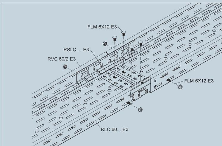
Die Stoßstellenverbindung erfolgt über die beiden Verbinder RVC 60/2 E3 und je 2 Stück Flachrundkopfschrauben FLM 6X12 E3 sowie der Stoßstellenleiste RSLC... und 4 Stück Flachrundkopfschrauben FLM 6X12 E3.
