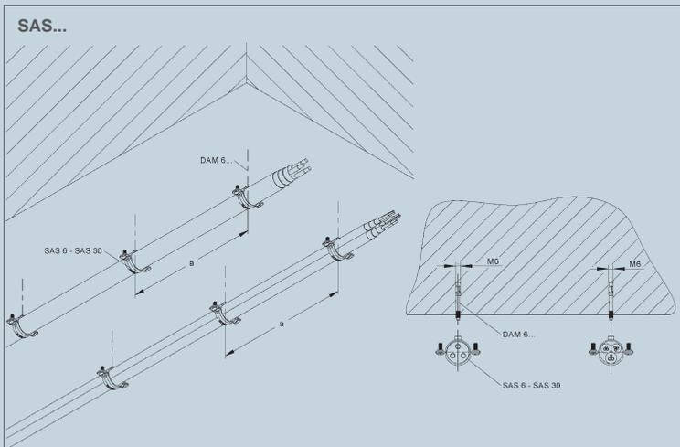
Bei vertikaler Verlegung mit Kabel- und Schraubabstandschiellen 85... und SAS... muss bei durchgehenden Kabelführungen über 3500 mm eine wirksame Abstützung der Kabel erfolgen (siehe Kapitel „3.1 Steigetrasse“). ➔120
