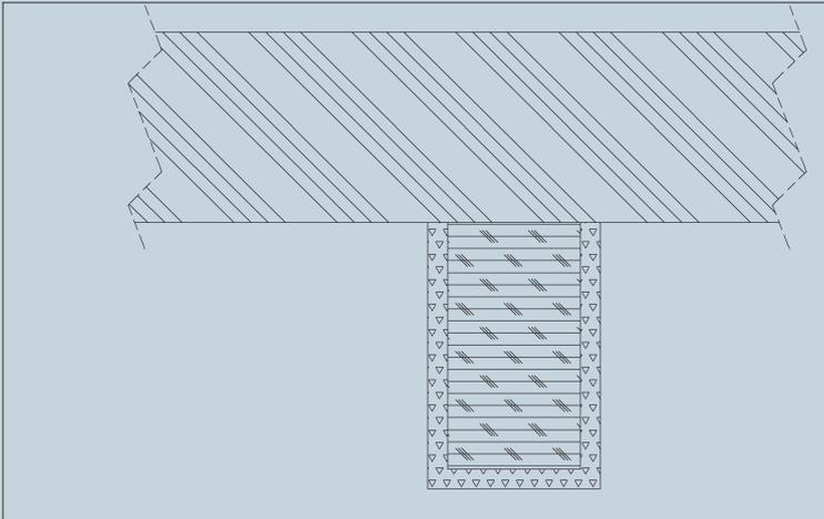
In Abhängigkeit von der Holzart und seiner Rohdichte gibt der Eurocode 5 eine Abbrandrate von 0,55 mm/min bzw. 0,8 mm/min an.
