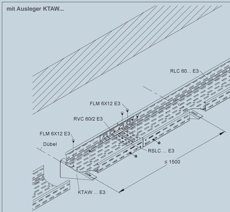
Kabelrinnen mit einer Holmhöhe von 60 mm, in den Breiten 100 bis 300 mm (RLC 60.100 E3 OV - RLC 60.300 E3 OV) finden Verwendung in der Wandmontage. Die Verbindung zweier Kabelrinnen RLC 60... erfolgt über die Stoßstellenverbinder RVC 60/2 E3 (je Verbinder 2 FLM 6X12 E3) und der Stoßstellenleiste RSLC... (4 FLM 6X12 E3). Die Kabelrinnen werden auf den Auslegern KTAW... mit 2 Flachrundkopfschrauben (FLM 6X12 E3) befestigt.
