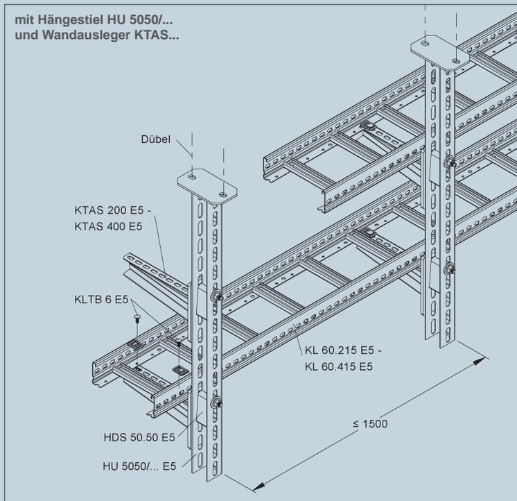
Kabelleitern mit einer Holmhöhe von 60 mm, in den Breiten 200 bis 400 mm mit einem Sprossenabstand von 150 mm (KL 60.215 - KL 60.415 E5) finden Verwendung bei der Deckenmontage. Die Kabelleitern werden auf den Auslegern mit 2 Kabelleiterbefestigungen KLTB 6 E5 befestigt.
