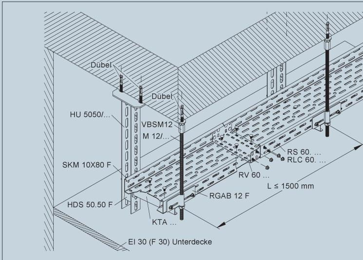
Kabelrinnen der Serien (RLC 60.100 - RLC 60.400) sowie (RS 60.100 - RS 60.600) finden Verwendung bei der Decken- und Wandmontage.
