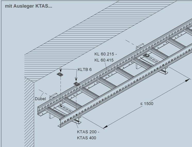
Kabelleitern mit einer Holmhöhe von 60 mm, in den Breiten 200 bis 400 mm mit einem Sprossenabstand von 150 mm (KL 60.215 - KL 60.415) finden Verwendung bei der Wandmontage. Die Kabelleitern werden auf den Auslegern mit 2 Kabelleiterbefestigungen KLTB 6 befestigt.
