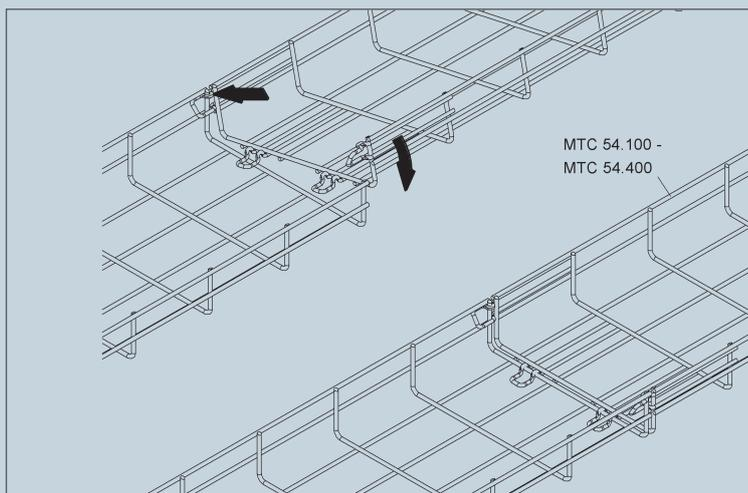
Die Verbindung zweier Gitterrinnen MTC 54... erfolgt über die angeschweißten Verbindertaschen einfach durch Zusammenstecken.
