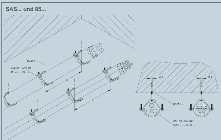
Die Ausführungen und Hinweise der gutachterlichen Stellungnahme Normtragekonstruktion sind zu berücksichtigen. Alternativ zu der verzinkten Stahlausführung kann auch Edelstahl verwendet werden.
