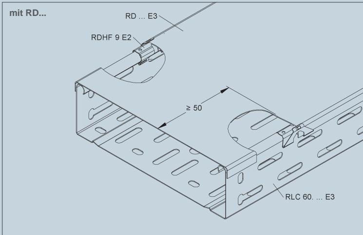
Kommen Deckel RDV... E3 und Formstückdeckel RTADV ... E3, RBADV ... E3, RESDV ... E3 und RTSDV ... E3 zum Einsatz, ist das max. zulässige Kabelgewicht um das Gewicht des Deckels zu reduzieren.
