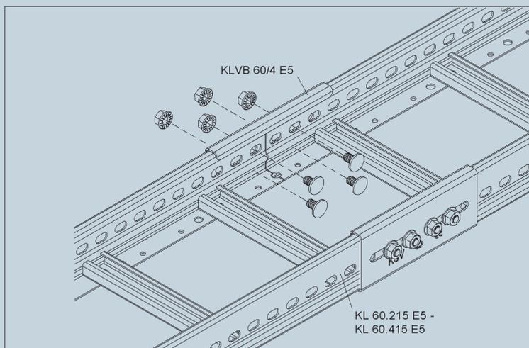
Die Verbindung zweier Kabelleiter KL 60... E5 erfolgt über die Kabelleiter-Längsverbinder KLVB 60/4 E5 mit 4 Flachrundkopfschrauben SKM 8X16 E5 je Verbinder.
