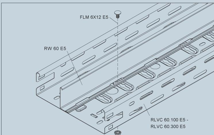
Um bei einer Mischbelegung eine Überlagerung von Leitungen der allgemeinen Stromversorgung und Sicherheitsstromversorgung zu vermeiden, kann ein Trennsteg RW 60 E5 verwendet werden.
