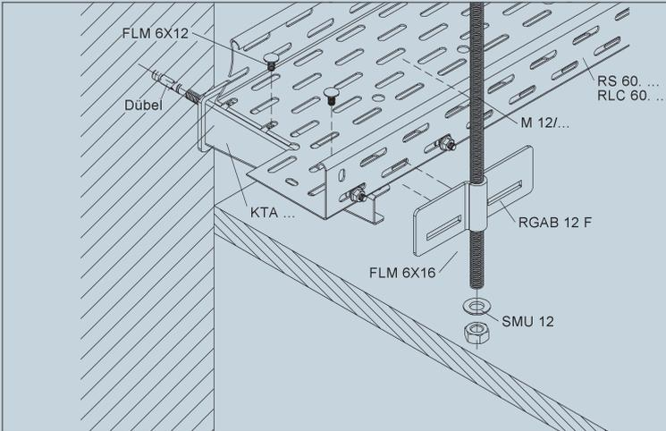
Die Stoßstellen werden gemäß nebenstehender Darstellungen montiert. Die Kabelrinnen werden auf den Auslegern mit 2 Flachrundkopfschrauben (FLM 6X12) montiert.
