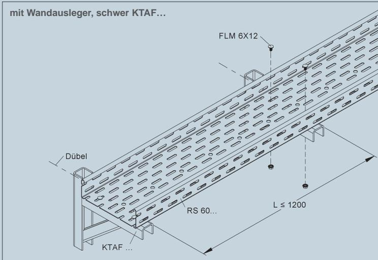
Kabelrinnen mit einer Holmhöhe von 60 mm, in den Breiten 200 bis 300 mm (RS 60.200 OV - RS 60.300 OV) finden Verwendung bei der Wandmontage. Die Verbindung zweier Kabelrinnen RS 60... erfolgt über die Stoßstellenverbinder RVV 60 (je Verbinder 4 FLM 6X12) und der Stoßstellenleiste RSLB... (4 FLM 6X12). Die Kabelrinnen werden auf den Auslegern mit 2 Flachrundkopfschrauben (FLM 6X12) befestigt.
