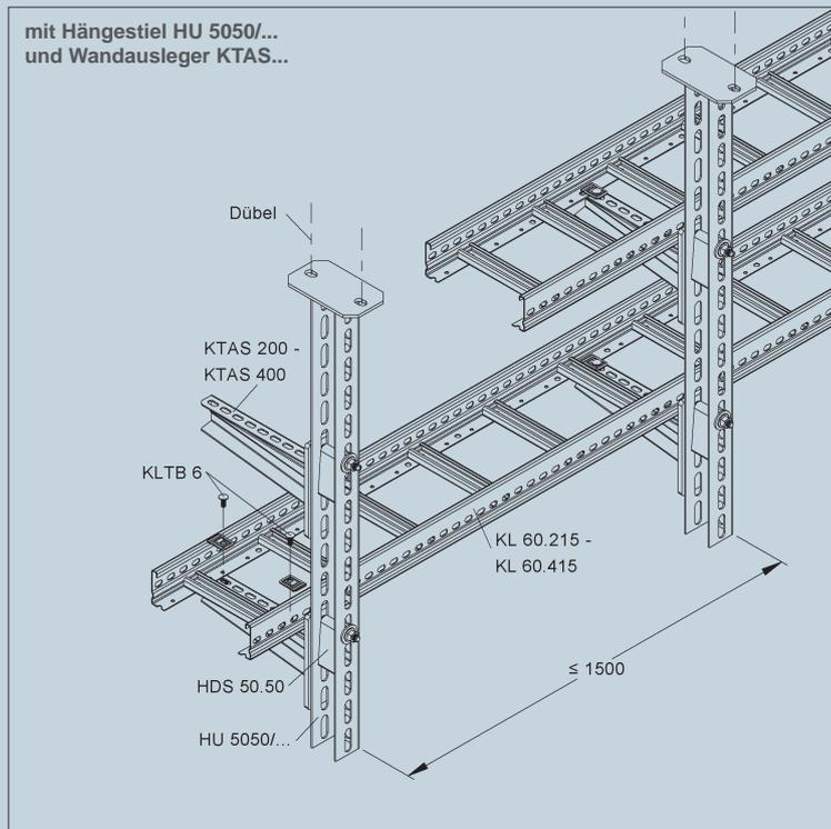
Kabelleitern mit einer Holmhöhe von 60 mm, in den Breiten 200 bis 400 mm mit einem Sprossenabstand von 150 mm (KL 60.215 - KL 60.415) finden Verwendung bei der Deckenmontage. Die Kabelleitern werden auf den Auslegern mit 2 Kabelleiterbefestigungen KLTB 6 befestigt.
