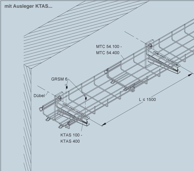
Gitterrinnen mit einer Holmhöhe von 54 mm, in den Breiten 100 bis 400 mm (MTC 54.100 - MTC 54.400) finden Verwendung bei der Decken- und Wandmontage.
