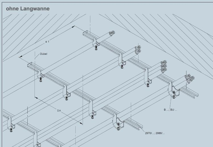
Bei vertikaler Verlegung mit Bügelschellen B... oder BU muss bei durchgehenden Kabelführungen über 3500 mm eine wirksame Abstützung der Kabel erfolgen (siehe Kapitel „3.1 Steigetrasse“) ➔ 120
