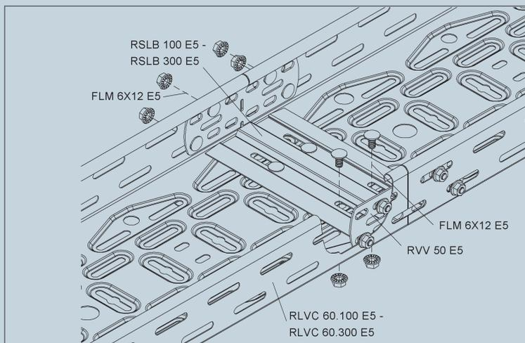
Alternativ kann bei geschnittenen Kabelrinnen die Verbindung über zwei innen liegenden Universalverbinder RVV 50 und einer Stoßstellenleiste RSLB... erfolgen. Die Lage der Stoßstellen ist nicht an einer bestimmten Position gebunden.
