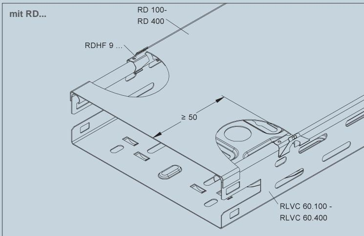
Kommen Deckel RD... mit Deckelhalterfeder RDHF 9 E2 bzw. RDV... und Formstückdeckel RTADV ..., RBADV ..., RESDV ..., RTSDV ... und RKSDV ... zum Einsatz, ist das max. zulässige Kabelgewicht um das Gewicht des Deckels zu reduzieren.
