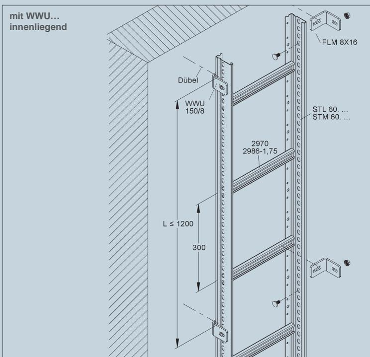
Die Befestigung der Steigetrassen am Baugrund erfolgt mit zugelassenen Dübels  $\geq$  M8 (siehe Kapitel „8 Befestigungselemente“  $\rightarrow$  256)
