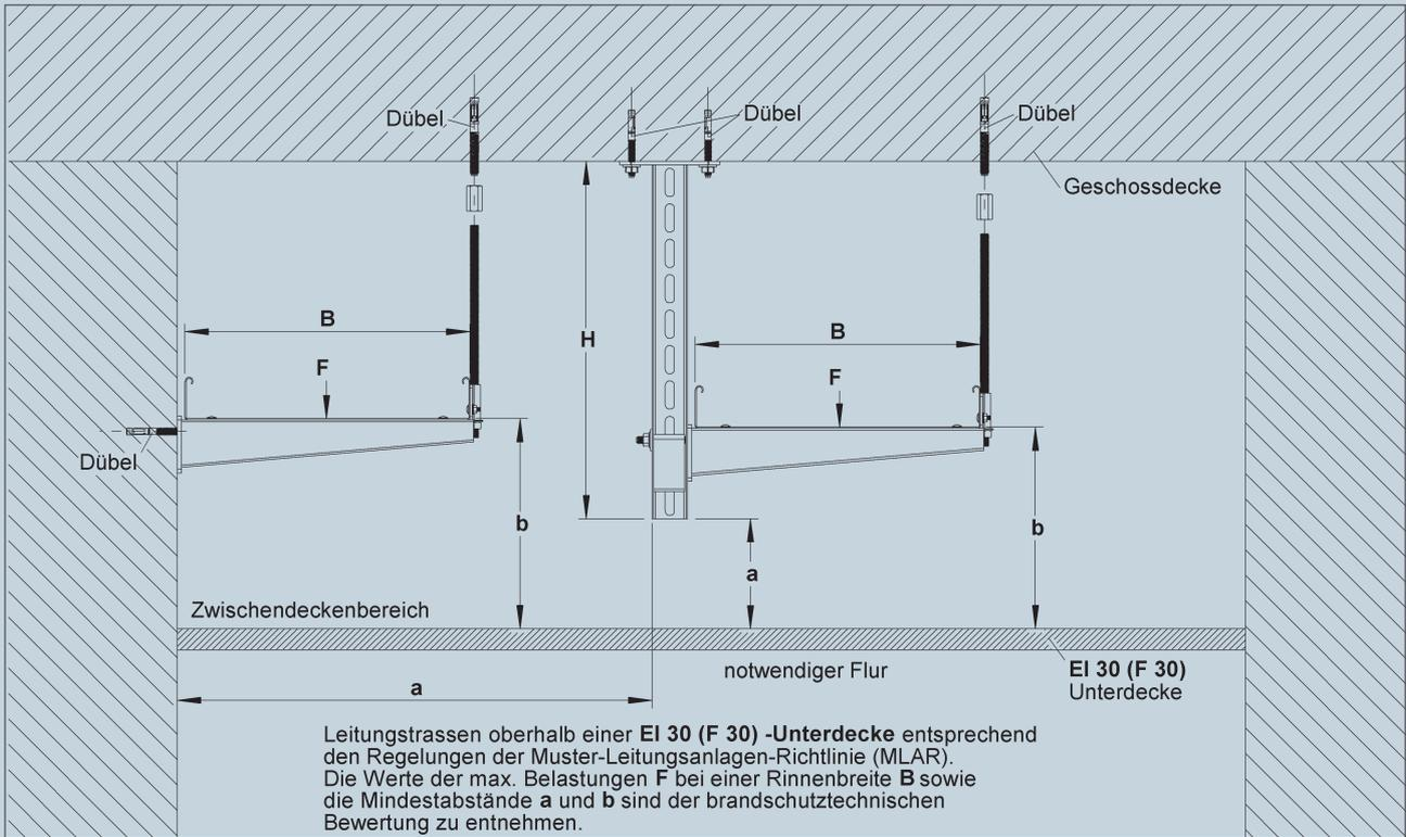
Die Ausführung und Werte der Durchbiegung bei Belastung gemäß untenstehender Tabelle sind der brandschutztechnischen Bewertung zu entnehmen.
