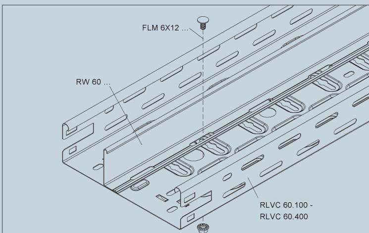
Um bei einer Mischbelegung eine Überlagerung von Leitungen der allgemeinen Stromversorgung und Sicherheitsstromversorgung zu vermeiden, kann ein Trennsteg RW... verwendet werden.
