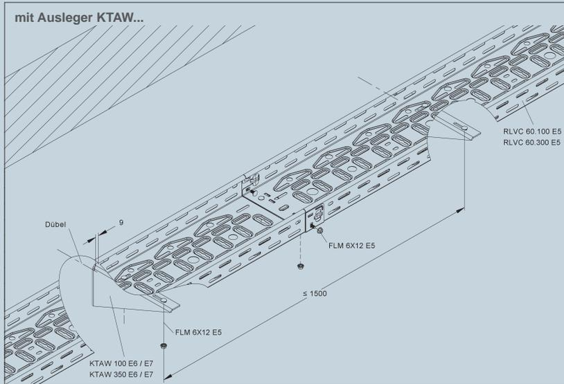
Kabelrinnen mit einer Holmhöhe von 60 mm, in den Breiten 100 bis 300 mm (RLVC 60.100 E5 - RLVC 60.300 E5) finden Verwendung bei der Decken- und Wandmontage. Die Kabelrinnen werden auf den Auslegern mit 2 Flachrundkopfschrauben FLM 6X12 E5 befestigt.
