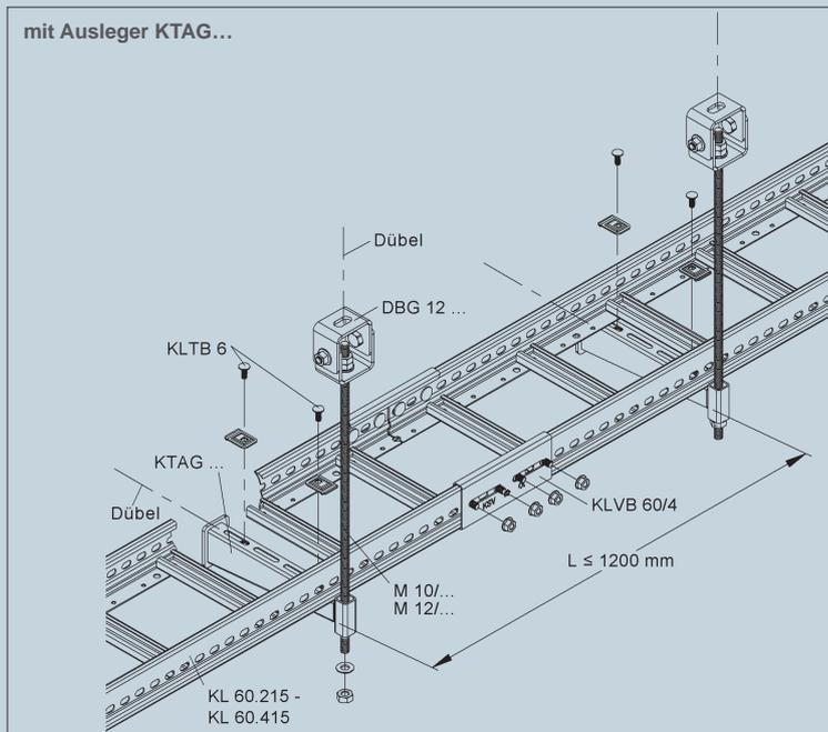
Kabelleitern mit einer Holmhöhe von 60 mm, in den Breiten 200 bis 400 mm (KL 60.215 - KL 60.415) finden Verwendung bei der Decken- und Wandmontage. Die Verbindung zweier Kabelleitern KL 60... erfolgt über die Längsverbinder KLVB 60/4 mit 4 Flachrundkopfschrauben FLM 8X13 F je Verbinder.
