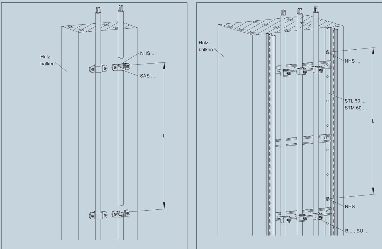
Alternativ können C-Profilschienen 2970... bzw. 2986... und Bügelzellen B... bzw. BU... eingesetzt werden.
