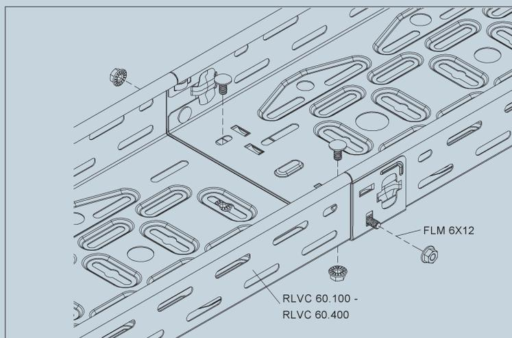
Die Stoßstellen-Verbindung erfolgt über den integrierten Verbinder und zusätzlich 4 Flachrundkopfschrauben FLM 6X12.
