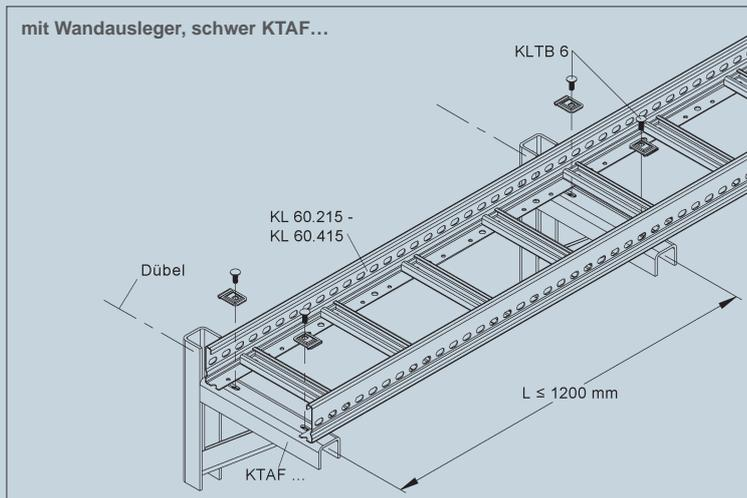
Kabelleitern mit einer Holmhöhe von 60 mm, in den Breiten 200 bis 400 mm (KL 60.215 - KL 60.415) finden Verwendung bei der Wandmontage.
