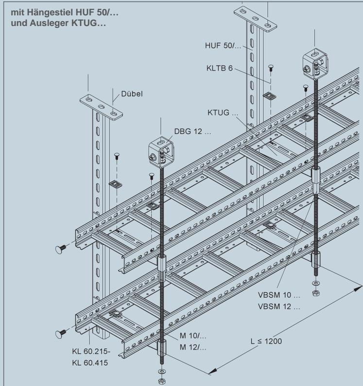
Kabelleitern mit einer Holmhöhe von 60 mm, in den Breiten 200 bis 400 mm (KL 60.215 - KL 60.415) finden Verwendung bei der Deckenmontage. Die Verbindung zweier Kabelleitern KL 60... erfolgt über die Längsverbinder KLVB 60/4 mit 4 Flachrundkopfschrauben FLM 8X13 F je Verbinder. Die Kabelleitern werden auf den Auslegern mit 2 Kabelleiterbefestigungen KLTB 6 befestigt.
