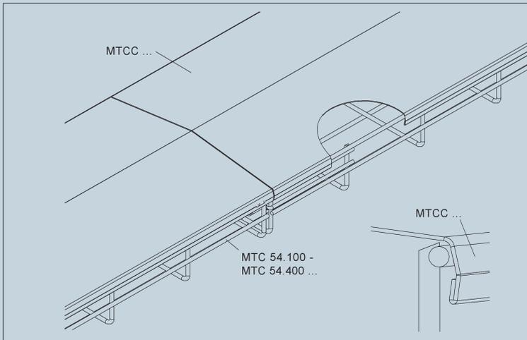
Werden Deckel MTCC... verwendet, ist das max. zulässige Kabelgewicht um das Gewicht des Deckels zu reduzieren.
