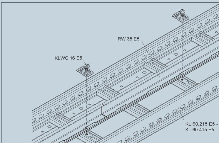
Um bei einer Mischbelegung eine Überlagerung von Leitungen der allgemeinen Stromversorgung und Sicherheitsstromversorgung zu vermeiden, kann ein Trennsteg RW... verwendet werden. Dieser wird mittels der Trennstegbefestigungsklemme KLWC 16 E5 in der Sprosse befestigt.
