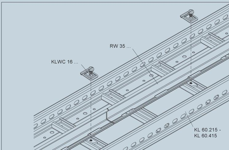
Um bei einer Mischbelegung eine Überlagerung von Leitungen der allgemeinen Stromversorgung und Sicherheitsstromversorgung zu vermeiden, kann ein Trennsteg RW... verwendet werden. Dieser wird mittels der Trennstegbefestigungsklemme KLWC 16 in der Sprosse befestigt.
