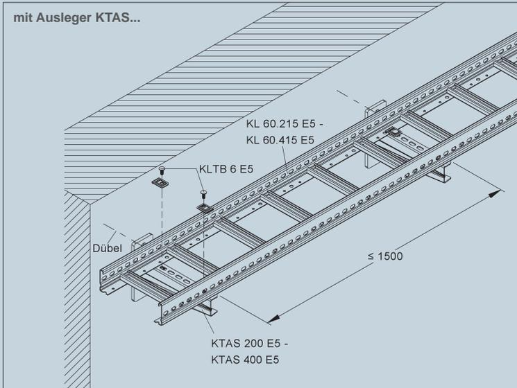
Kabelleitern mit einer Holmhöhe von 60 mm, in den Breiten 200 bis 400 mm mit einem Sprossenabstand von 150 mm (KL 60.215 - KL 60.415 E5) finden Verwendung bei der Wandmontage. Die Kabelleitern werden auf den Auslegern mit 2 Kabelleiterbefestigungen KLTB 6 E5 befestigt.
