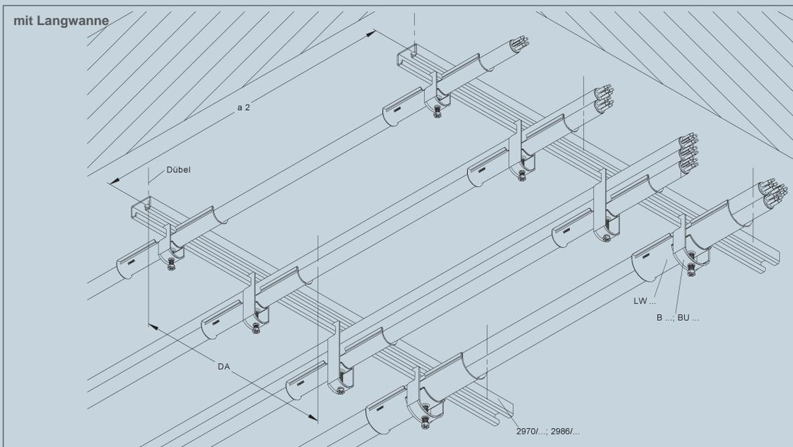
Bei der horizontalen Kabelverlegung auf der Wand mit Bügelschelle und C-Profilschienen muss sichergestellt sein, dass im Brandfall die Bügelschellen nicht seitlich aus dem C-Profil abrutschen.
