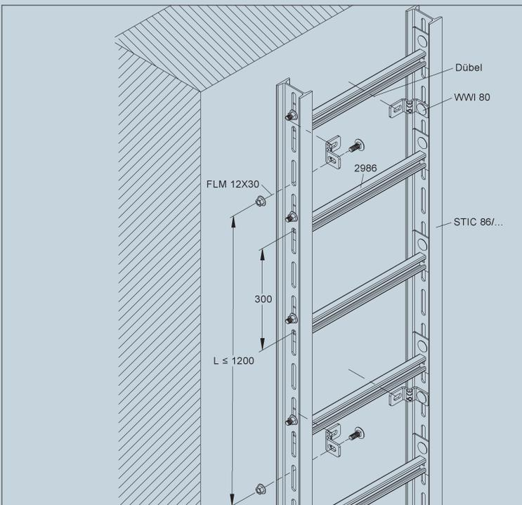
Die Befestigung der Steigetrasse am Baugrund erfolgt mit zugelassenen Dübel  $\geq$  M10 (siehe Kapitel „8 Befestigungselemente“  $\rightarrow$  256 )
