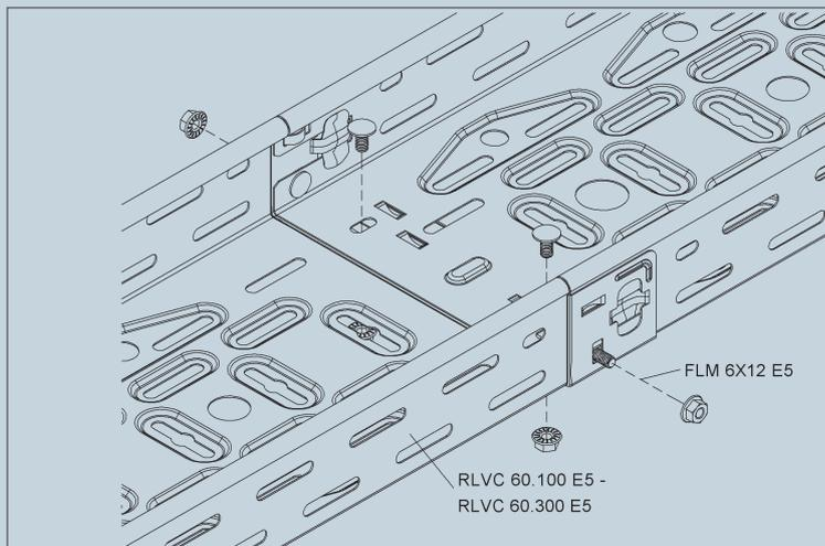
Die Stoßstellen-Verbindung erfolgt über den integrierten Verbinder und zusätzlich 4 Flachrundkopfschrauben FLM 6X12 E5.
