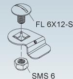
Bei der Befestigung ist darauf zu achten, dass ein Mindestabstand von  $\geq 50$  mm zum Deckelanfang/-ende eingehalten werden muss.
