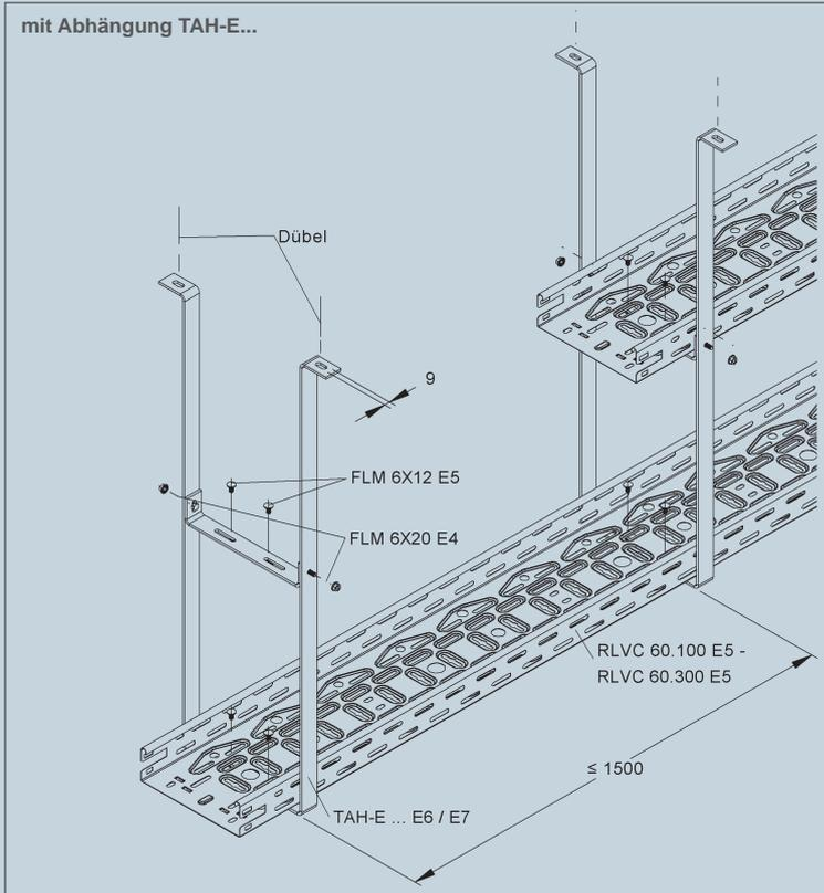
Bei der Deckenmontage können Kabelrinnen mit einer Holmhöhe von 60 mm, in den Breiten 100 bis 300 mm (RLVC 60.100 E5 - RLVC 60.300 E5) verwendet werden.
