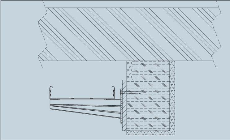
Wird zwischen dem Funktionserhalt Verlege System und dem Holzträger eine Brandschutzplatte der Baustoffklasse A gemäß EN 13501-1 mit einer Feuerwiderstandsklasse F30 bzw. F60 montiert, so wird in diesem Bereich ein Abbrand des Holzträgers vermieden und ein negativer Einfluss auf die Tragfähigkeit des Holzträgers und des Funktionserhalt Verlege Systems verhindert.
