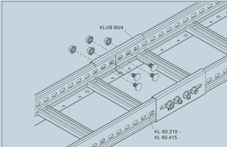
Die Verbindung zweier Kabelleitern KL 60... erfolgt über die Längsverbinder KLVB 60/4 mit 4 Flachrundkopfschrauben FLM 8X13 F je Verbinder gemäß nebenstehender Abbildung.
