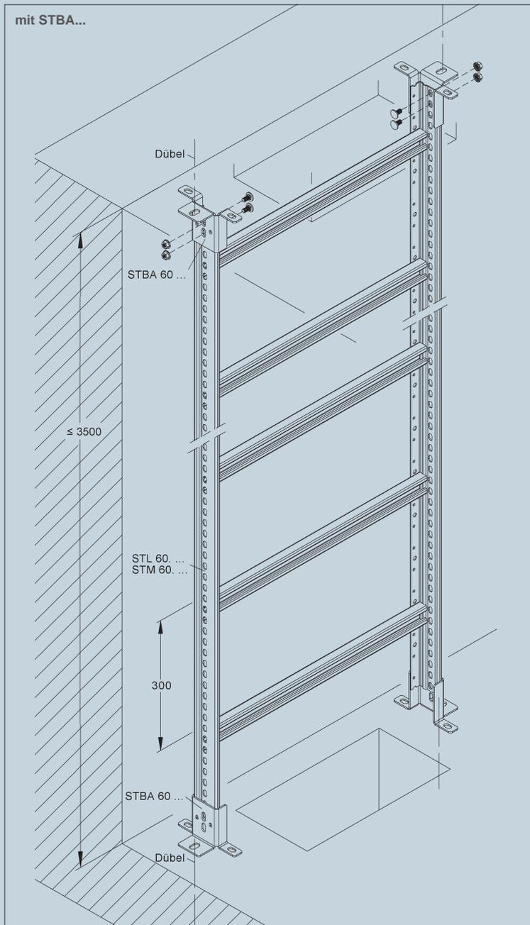
Die Befestigung des Steigetrassen-Befestigungsadapters am Seitenholm der Steigetrasse erfolgt mit 2 Flachrundkopfschrauben FLM 8X16.
