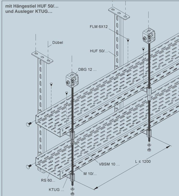
Kabelrinnen mit einer Holmhöhe von 60 mm, in den Breiten 100 bis 300 mm (RS 60.100 OV - RS 60.300 OV) finden Verwendung bei der Deckenmontage. Die Verbindung zweier Kabelrinnen RS 60... erfolgt über die Stoßstellenverbinder RVV 60 (je Verbinder 4 FLM 6X12). Die Kabelrinnen werden auf den Auslegern mit 2 Flachrundkopfschrauben (FLM 6X12/ FLM 6X16 F) befestigt.
