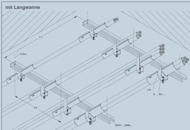
Bei der horizontalen Kabelverlegung auf der Wand mit Bügelschelle und C-Profilschienen muss sichergestellt sein, dass im Brandfall die Bügelschellen nicht seitlich aus dem C-Profil abrutschen. Die Ausführung und Hinweise der gutachterlichen Stellungnahmen Normtragekonstruktion sind zu berücksichtigen. Alternativ zu der verzinkten Stahlausführung kann auch Edelstahl verwendet werden.
