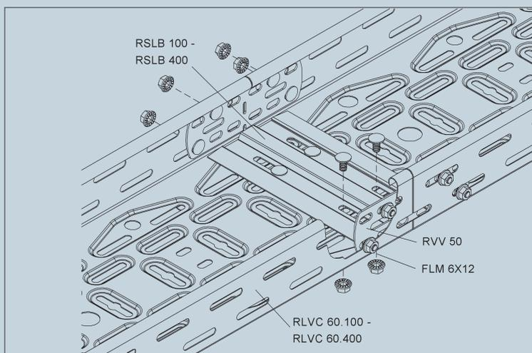
Alternativ kann bei geschnittenen Kabelrinnen die Verbindung über zwei innen liegenden Universalverbinder RVV 50 und einer Stoßstellenleiste RSLB... erfolgen. Die Lage der Stoßstellen ist nicht an einer bestimmten Position gebunden.
