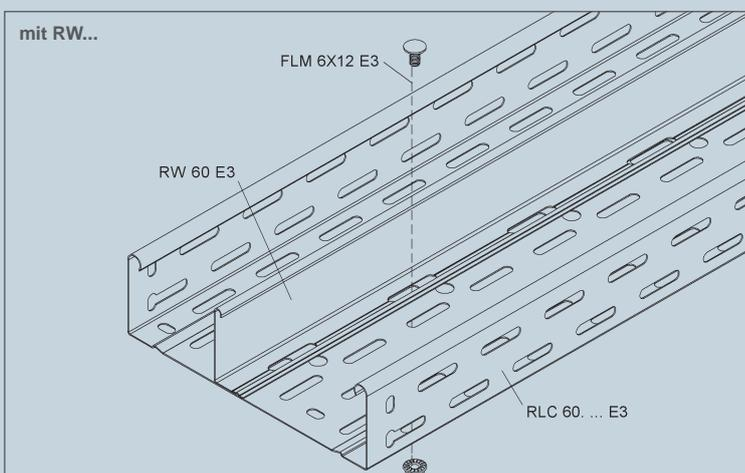
Um bei einer Mischbelegung eine Überlagerung von Leitungen der allgemeinen Stromversorgung und Sicherheitsstromversorgung zu vermeiden, kann ein Trennsteg RW 60 E3 verwendet werden.
