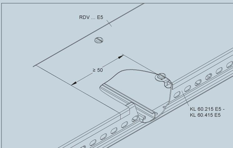
Werden Deckel RDV... E5 verwendet, ist das max. zulässige Kabelgewicht um das Gewicht des Deckels zu reduzieren.
