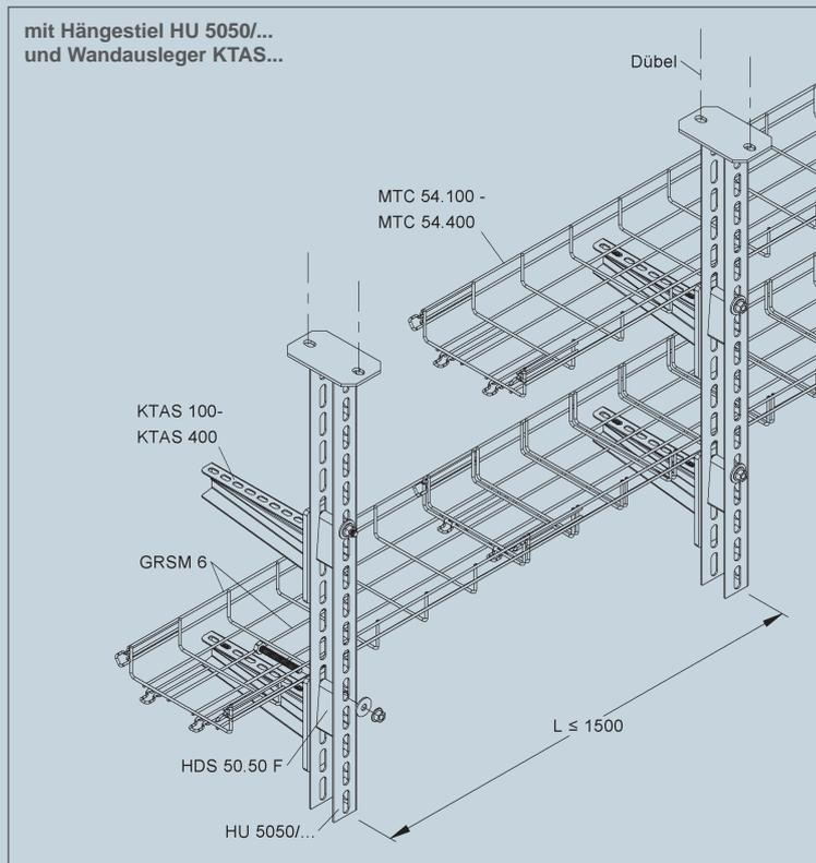
Gitterrinnen mit einer Holmhöhe von 54 mm, in den Breiten 100 bis 400 mm (MTC 54.100 - MTC 54.400) finden Verwendung bei der Decken- und Wandmontage. Die Gitterrinnen werden auf den Auslegern mit 2 Hakenschrauben GRSM 6 befestigt.
