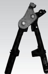
Spezialwerkzeug zum schnellen Spannen der Gripplle Drahtseile
