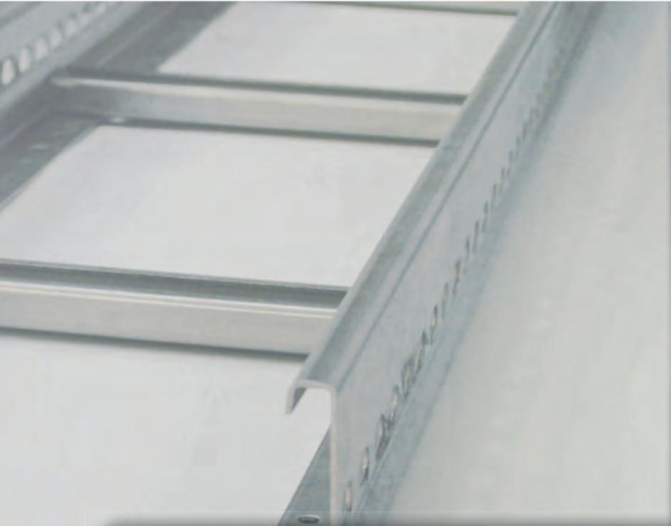
Das Steigetrassen-System läßt sich mittels Dübel ohne Zubehör direkt befestigen und weist zudem die gleichen Vorteile wie das Kabelleiter-System auf: Hohe Tragfähigkeit durch die Holmform, stufen- und bohrlose Verschraubung der Wandanschlussteile dank durchgehender Seitenholmlochung, Schnellbefestigung der zu spannenden Elemente mittels Bügelschellen auf den C-Profil-/Winkleisensprossen.
