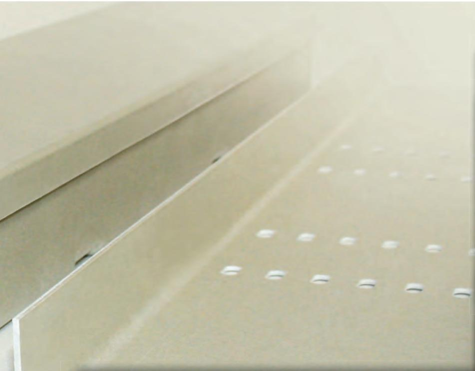
Das GFK-Kabelrinnensystem K<sup>2</sup> von Ebo aus gepressten Glasfasermatten besteht durch eine zeitsparende und schraublose Montage. Durch die angeformte Muffenverbindung lassen sich die Systembauteile einfach und schnell bei einem maximalen Befestigungsabstand von 1,5 m zusammenstecken. Diese Muffenverbindung ist zudem selbstregulierend, das heißt die Ausdehnungsdistanz wird immer eingehalten.
